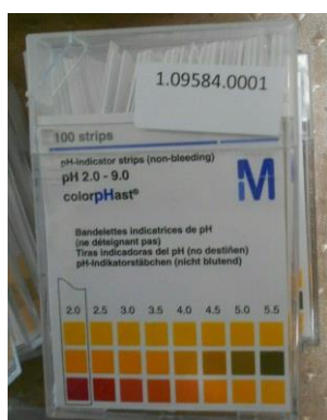
Foto 4: pH H 2 O-indicatorstrips voor de bodem (links) en de strips in het humus- en bodemprofiel.
