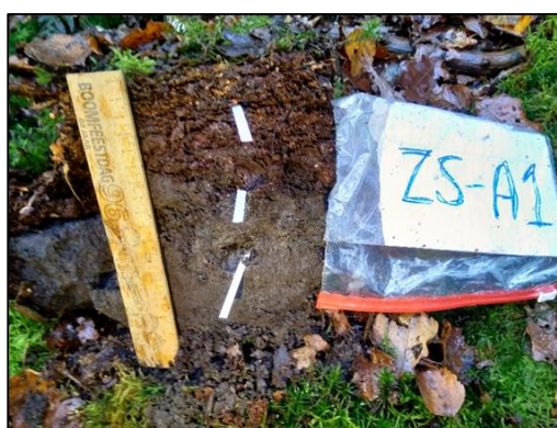
Foto 4: pH H 2 O-indicatorstrips voor de bodem (links) en de strips in het humus- en bodemprofiel.
